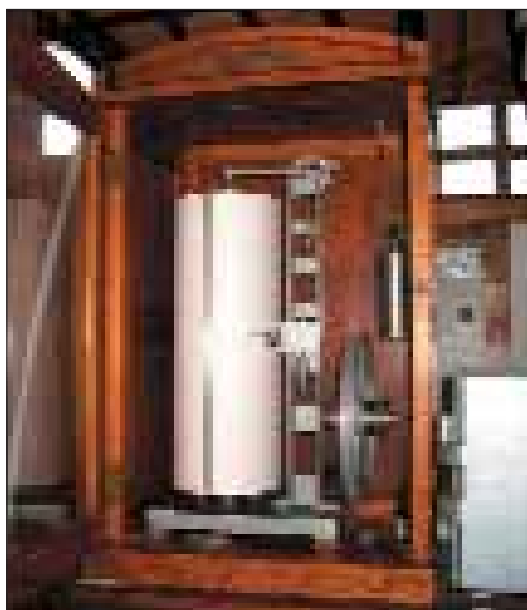
(Figura 5 – Stazione Mareografica di Venezia, Punta della Salute. - Idrometrografo a registrazione giornaliera tipo G440)
