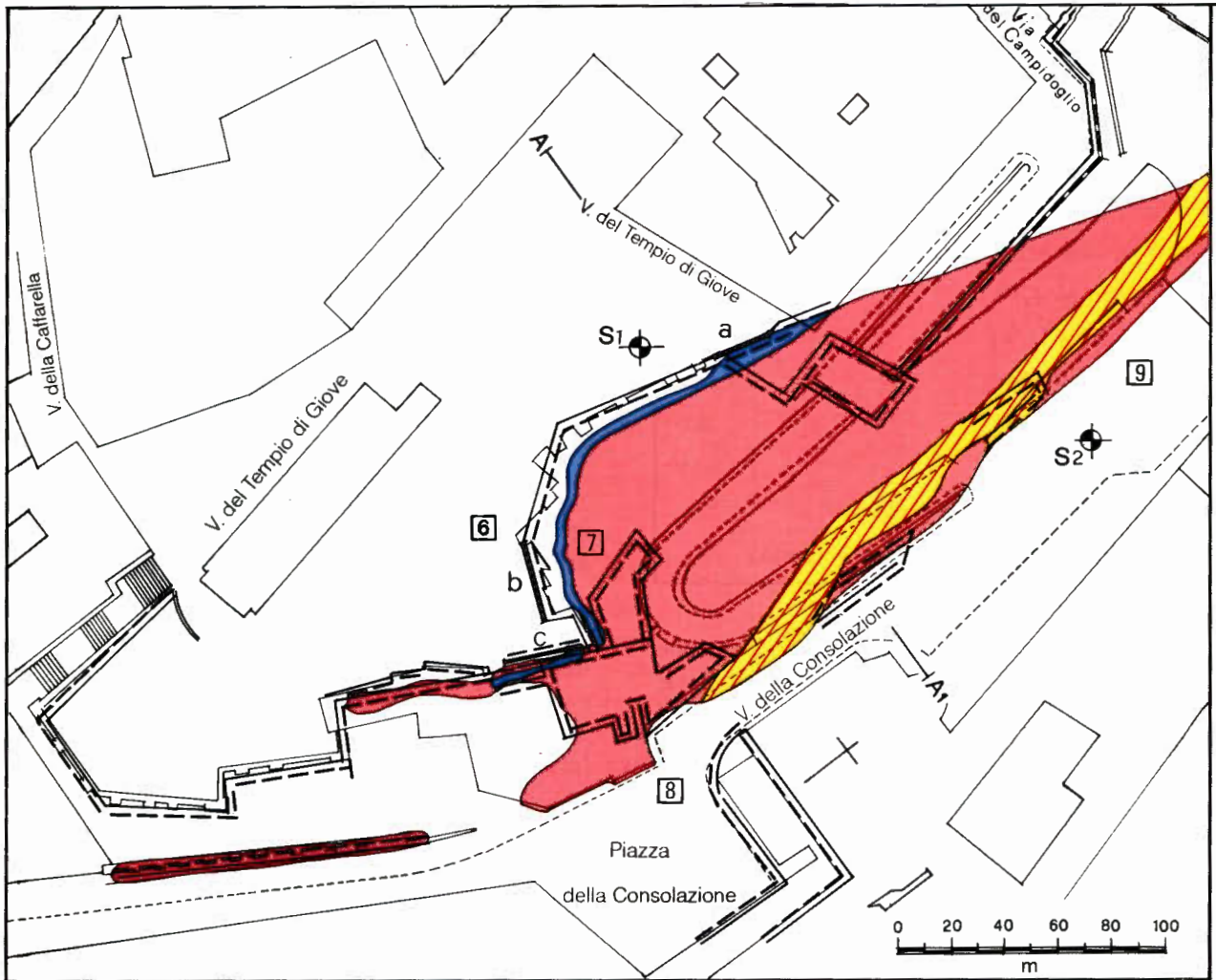
IL CAMPIDOGLIO: Crolli in corrispondenza delle scarpate: planimetria e sezione geologico - tecnica.
