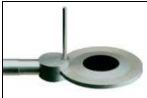
Fig. 2.63: radiometro netto di nuova costruzione (Kipp&Zonen)
