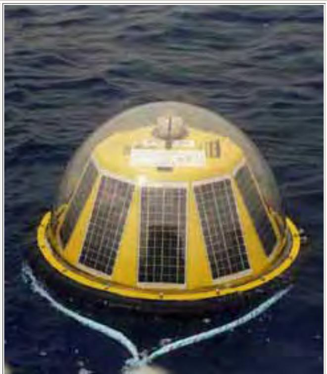
Fig 2.A Boa accelerometrica di tipo Triaxys
