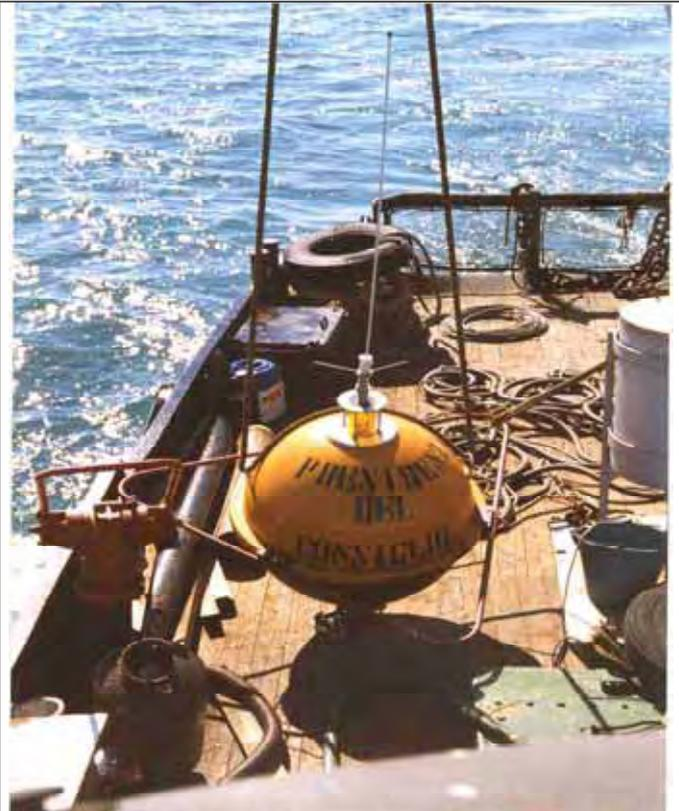
*Fig 1.B Boa accelerometrica direzionale Datawell waverider*
