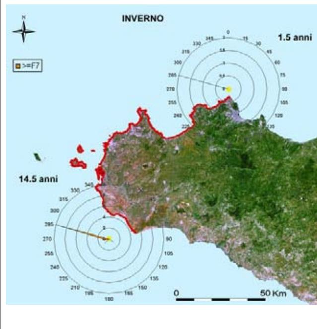
Fig 3.5.7 Rappresentazione delle tabelle a doppia entrata  $H_{m0}$ - $\alpha$  Tab 1.60 e Tab 1.70 - onde alte - tratto costiero da C.po Gallo a C.po Granitola – dati triorari, periodo: inverno
