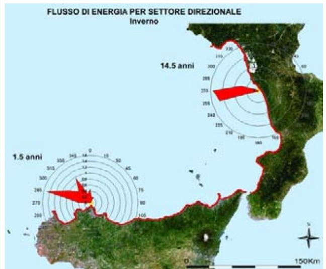
Fig 3.4.8 Media annuale del flusso lordo di energia in Kw/m per settori direzionali di 15° - tratto costiero da C.po Palinuro a C.po S.Vito – dati triorari, periodo: inverno
