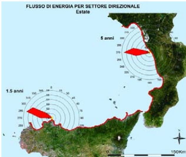
Fig 3.4.13 Media annuale del flusso lordo di energia in Kw/m per settori direzionali di 15° - tratto costiero da C.po Palinuro a C.po S.Vito – dati triorari, periodo: estate
