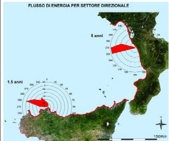
Fig 3.4.3 Rappresentazione delle tabelle a doppia entrata  $H_{m0}$ - $\alpha$  Tab 1.51 e Tab 1.59 - onde alte - tratto costiero da C.po Palinuro a C.po S.Vito – dati triorari, periodo: intero
