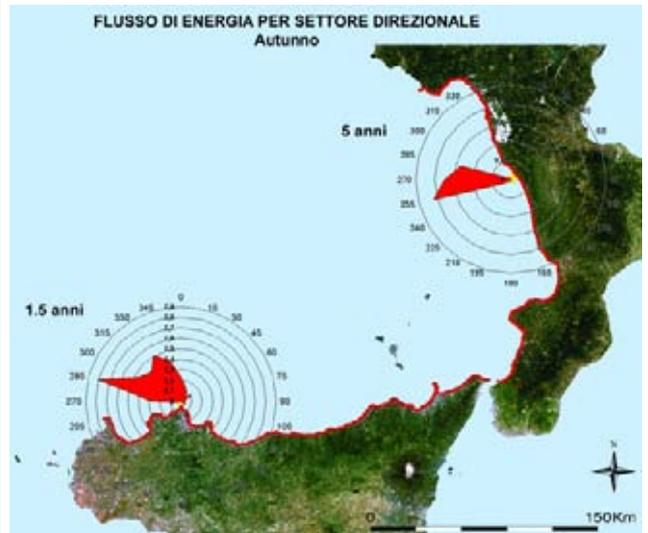
Fig 3.4.17 Media annuale del flusso lordo di energia in Kw/m per settori direzionali di 15° - tratto costiero da C.po Palinuro a C.po S.Vito – dati triorari, periodo: autunno
