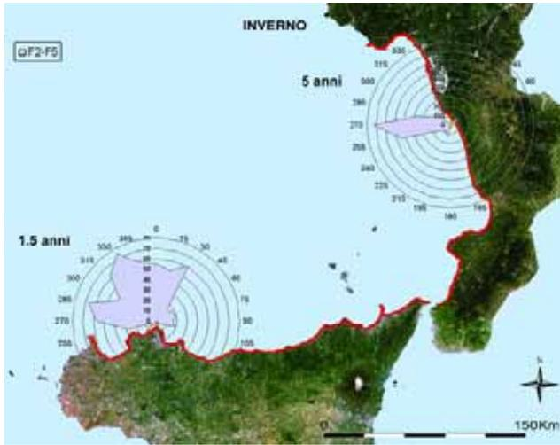
Fig 3.4.5 Rappresentazione delle tabelle a doppia entrata  $H_{m0}-\alpha$  Tab 1.52 e Tab 1.60 - onde basse - tratto costiero da C.po Palinuro a C.po S.Vito – dati triorari, periodo: inverno
