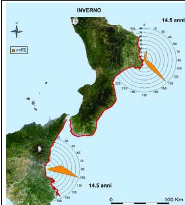
Fig 3.7.7 Rappresentazione delle tabelle a doppia entrata  $H_{m0}-\alpha$  Tab 1.80 e Tab 1.89 - onde alte - tratto costiero da C.po Murro di Porco a P.ta Alice – dati triorari, periodo: inverno
