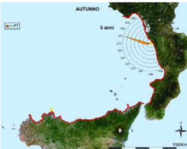
Fig 3.4.16 Rappresentazione delle tabelle a doppia entrata  $H_{m0}$ - $\alpha$  Tab 1.55 e Tab 1.63 - onde alte - tratto costiero da C.po Palinuro a C.po S.Vito – dati triorari, periodo: autunno
