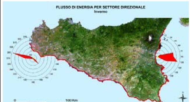
Fig 3.6.8 Media annuale del flusso lordo di energia in Kw/m per settori direzionali di  $15^\circ$  - tratto costiero da Marsala a C.po S.Alessio – dati triorari, periodo: inverno
