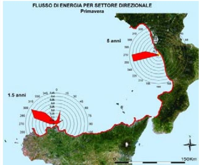
Fig 3.4.9 Rappresentazione delle tabelle a doppia entrata  $H_{m0}-\alpha$  Tab 1.53 e Tab 1.61 - onde basse - tratto costiero da C.po Palinuro a C.po S.Vito – dati triorari, periodo: primavera
