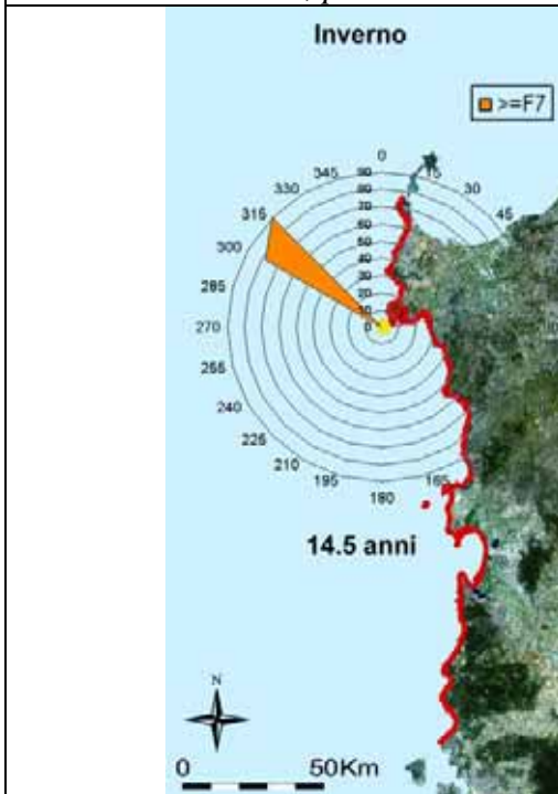
Fig 3.12.7 Rappresentazione della tabella a doppia entrata H_{m0}-\alpha Tab 1.2 - onde alte - tratto costiero da C.po del Falcone a C.po Altano- dati triorari, periodo: inverno
