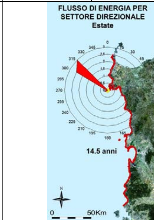
Fig 3.12.16 Media annuale del flusso lordo di energia in Kw/m per settori direzionali di 15^\circ - tratto costiero da C.po del Falcone a C.po Altano- dati triorari, periodo: estate
