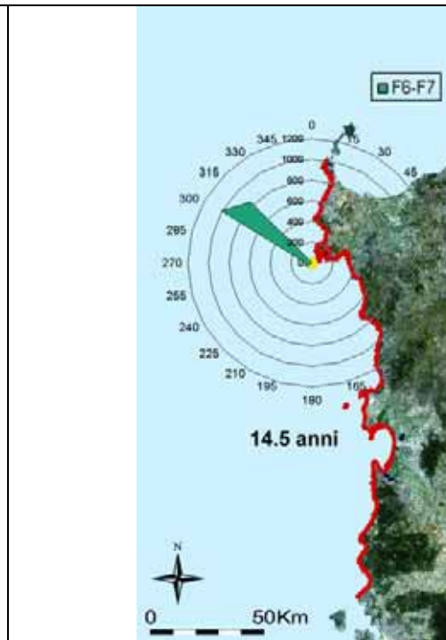
Fig 3.12.2 Rappresentazione della tabella a doppia entrata H_{m0}-\alpha Tab 1.1 - onde medie - tratto costiero da C.po del Falcone a C.po Altano- dati triorari, periodo: intero
