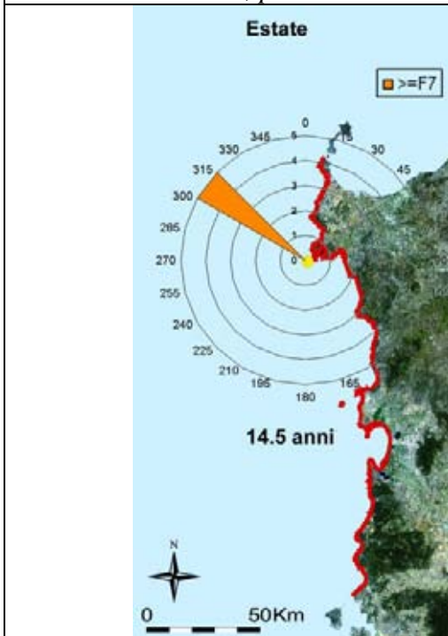
Fig 3.12.15 Rappresentazione della tabella a doppia entrata H_{m0}-\alpha Tab 1.4 - onde alte - tratto costiero da C.po del Falcone a C.po Altano- dati triorari, periodo: estate
