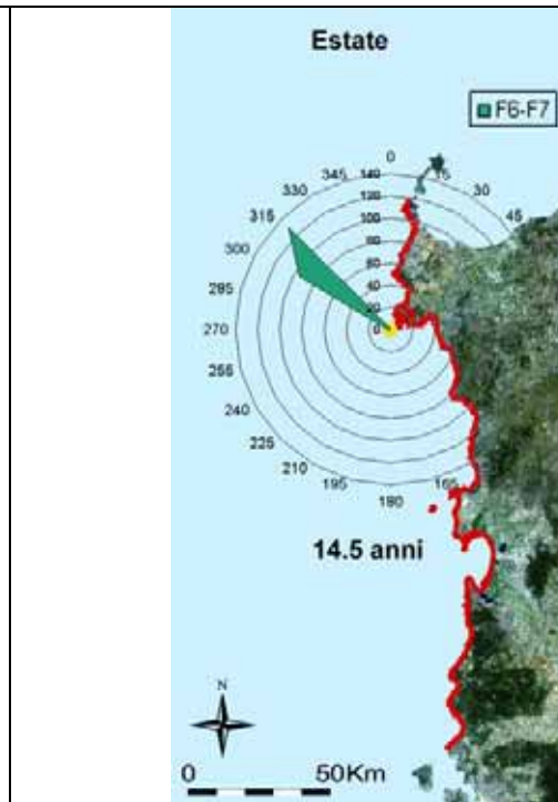
Fig 3.12.14 Rappresentazione della tabella a doppia entrata H_{m0}-\alpha Tab 1.4 - onde medie - tratto costiero da C.po del Falcone a C.po Altano- dati triorari, periodo: estate
