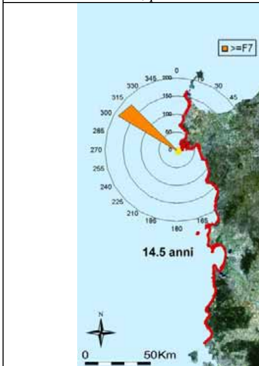
Fig 3.12.3 Rappresentazione della tabella a doppia entrata H_{m0}-\alpha Tab 1.1 - onde alte - tratto costiero da C.po del Falcone a C.po Altano- dati triorari, periodo: intero
