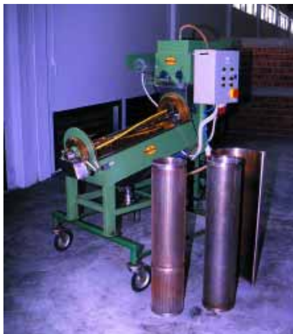
Figura 8.1. Macchina denocciolatrice impiegata per l'estrazione del seme dai frutti carnosì (foto Stabilimento Produzione Sementi Forestali Peri, VR, MIPAF)
