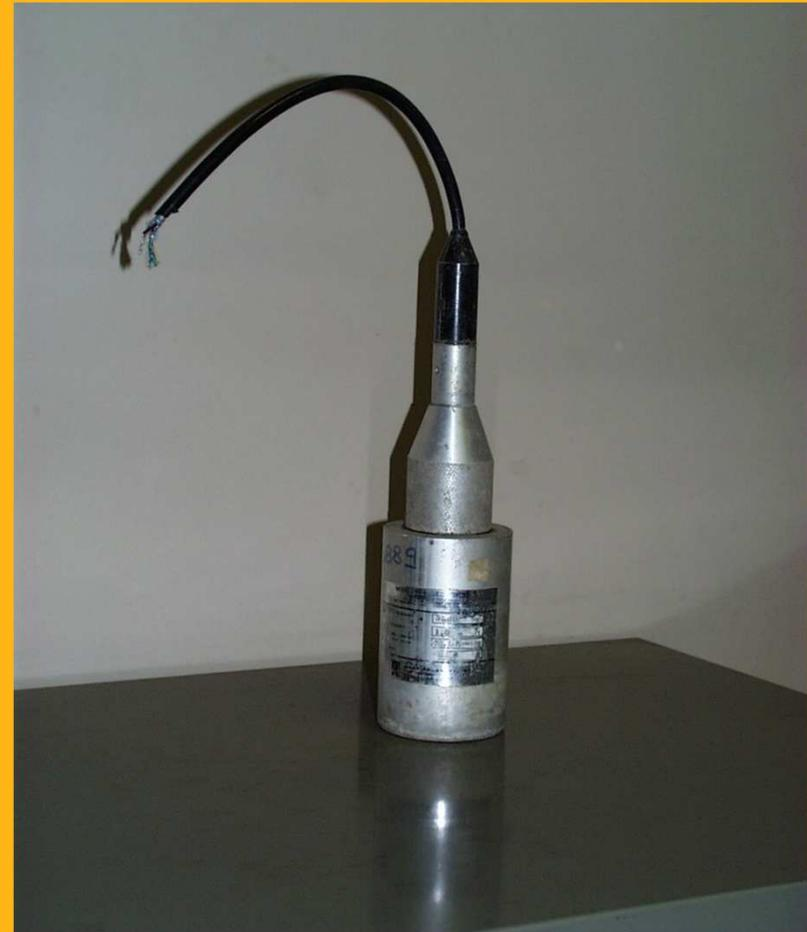
Sensori sismici - aspetti positivi: sensore non a contatto con la colata; installazione lungo le sponde del torrente (più semplice e sicura rispetto, ad esempio, ai sensori ad ultrasuoni).
