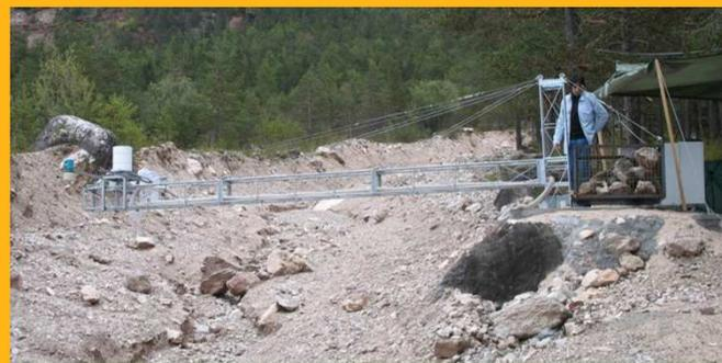
Stazione di valle: pluviografo, sensore di livello a ultrasuoni, geofoni, telecamera
