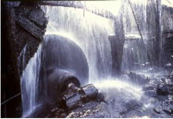
Ruota ad acqua per l'azionamento dei magli
