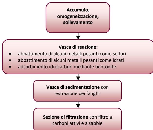
Figura 21: Schema delle fasi del processo di depurazione
