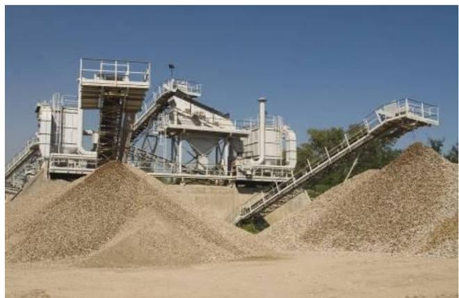
**Figura 13: Vista dell'impianto recupero inerti di Eureko S.r.l.**
