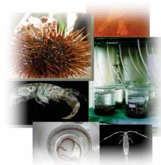
Specie marine impiegate nel laboratorio di eco tossicologia e particolare di becker usati come camere- test per la tossicità del sedimento
