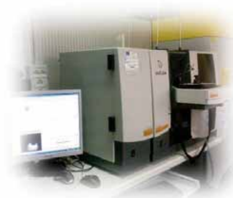
Strumento analitico per la determinazione dei metalli pesanti (AAS)
