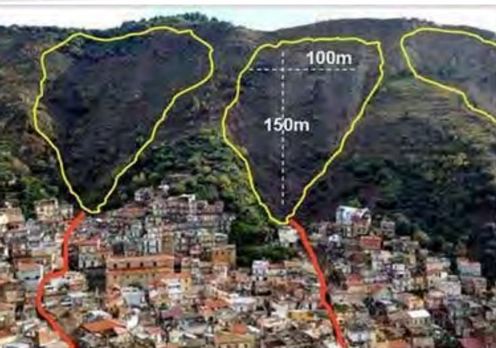
Versanti interessati dall'innescò ed evoluzione delle colate di fango Alvei-strada percorsi e devastati dalle colate rapide di fango e detriti fino alla fiumara
