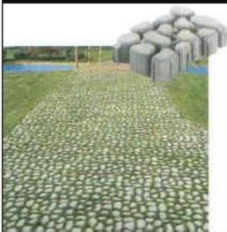
REALIZZARE PAVIMENTAZIONI ESTERNE DRENANTI EVITA ACCUMULI D' ACQUA STAGNANTI SU PAVIMENTAZIONI IMPERMEABILI E RIDUCE L' EFFETTO DI ISOLA DI CALORE.
