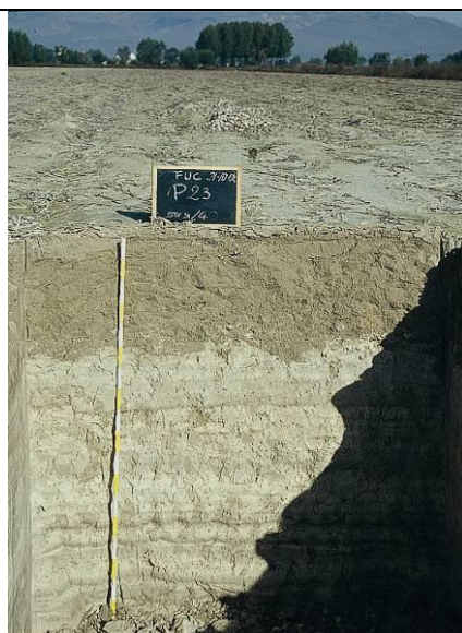
Foto 3.14: Suolo della bonifica del Fucino. Classificazione USDA: Typic Fluvaquents coarse-silty, carbonatic, mesic . Località: Piana del Fucino, Ortucchio, L'Aquila. (Foto Chiuchiarelli, Paolanti, Santucci ARSSA Abruzzo)
