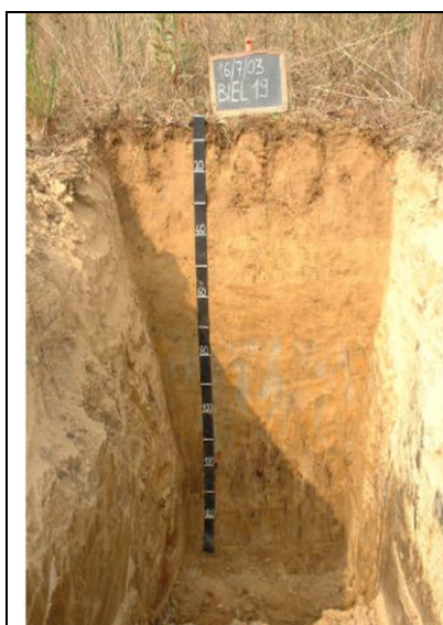
Foto 3.1: Suolo molto evoluto su depositi limosi di origine glaciale. Caratteri di idromorfia a partire da 70 cm. Classificazione USDA: Aquic Fraglossudalf, fine-silty, mixed, nonacid, mesic. Località: C.NA REGINA. Val Grande Piemonte (Foto Petrella, IPLA SpA)
