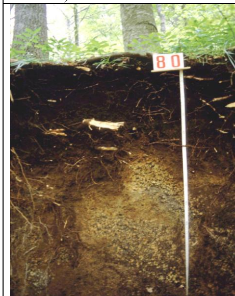
Foto 3.10: Suolo con caratteristiche Andiche molto sviluppate, su lave a Leucite. Classificazione USDA: Typic fulviudand . Località: S. Martino al Cimino. Viterbo (Foto Paolanti)
