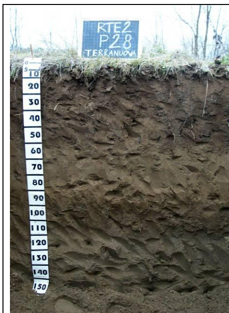
Foto 3.7: Suolo poco evoluto su depositi alluvionali. Suolo profondo, non calcareo, a tessitura grossolana. Classificazione USDA: Typic Ustifluvent coarse loamy mixed mesic . Località: Terranova Bracciolini. Arezzo (Foto Castellani)
