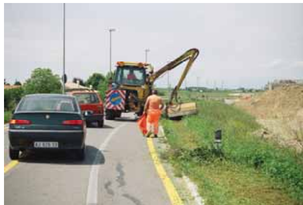
Foto 125 – idem manutenzioni con barra rotante – Foto G. Sauli 2006)
