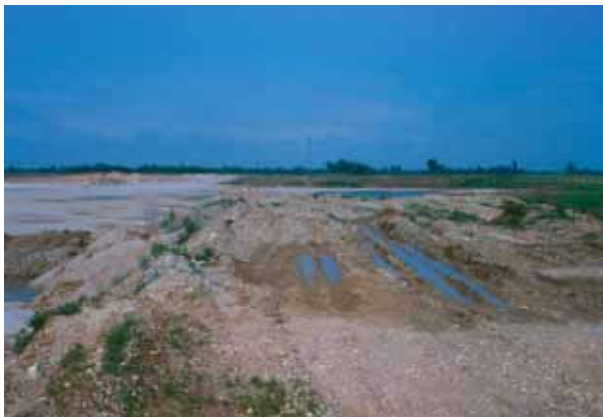
Foto 110 - Cava di ghiaia di prestito coltivata a piano ribassato con riutilizzo totale all'uso agricolo (Stradalta loc. Gonars –UD- Foto G. Sauli giugno 1983)
