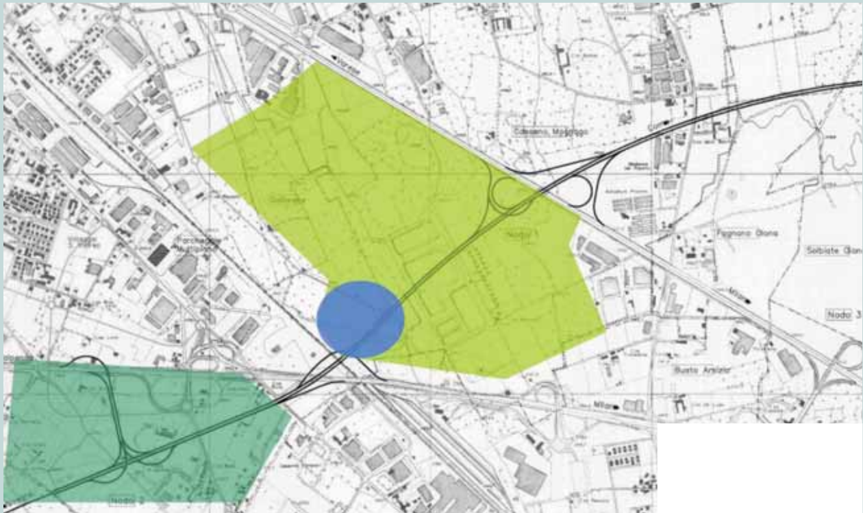
Fig. 54 Gallarate, (Va). Progetto preliminare di una nuova strada di scorrimento veloce che intercetta un'area di importanza naturalistica (verde chiaro), una zona umida di neo formazione (azzurro, vedi Box 1) e l'area di un nuovo parco tecnologico (verde scuro): il tracciato intercetta in modo rilevante tutta l'area che si trova, tra l'altro, in fascia B del Piano di assetto idrogeologico del bacino del Po (fascia di esondazione), deve pertanto essere realizzata interamente in viadotto. Di seguito le proposte di miglioramento del tracciato e le compensazioni possibili.
