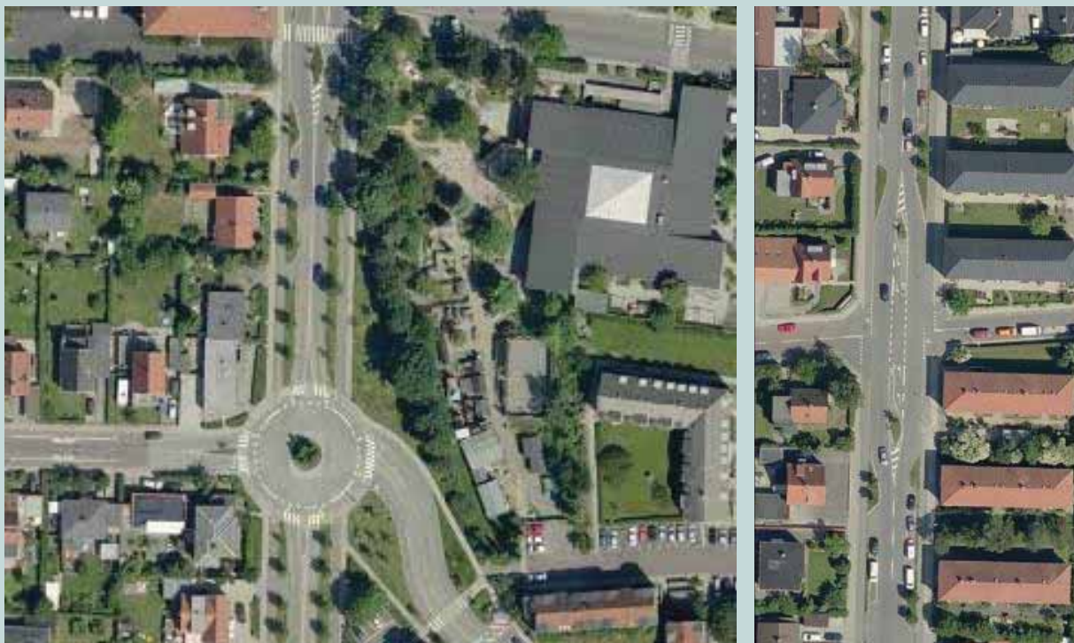
Figg. 47, 48 Comune di Rødovre, Danimarca. Ristrutturazione di strada di interquartiere da quattro a due corsie con pista ciclabile e parcheggi.
