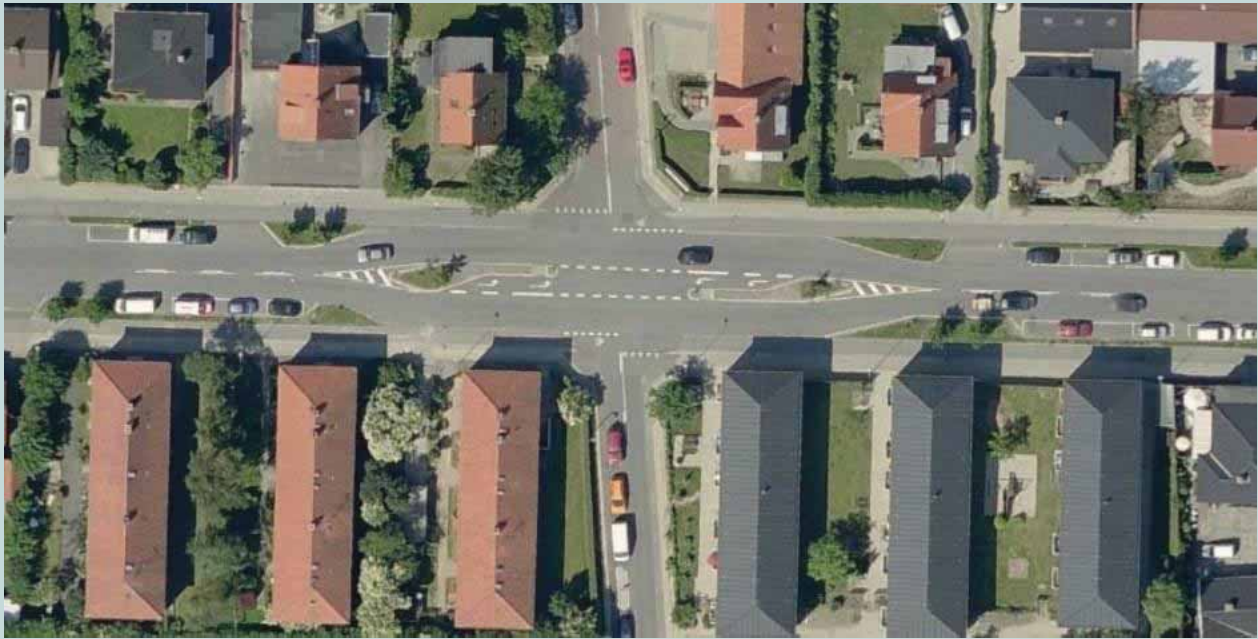
Fig. 43 Comune di Rødovre, Danimarca. Le aiuole definiscono un tragitto non rettilineo per rallentare il traffico, ridisegnando la strada e ordinano i parcheggi.
