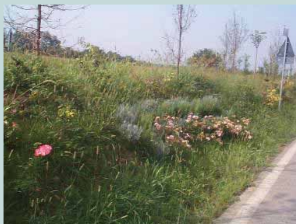
Figg. 123, 124 Esempio di barriera antirumore in rilevato lungo strada, con inserimento di vegetazione ornamentale e di consolidamento.
