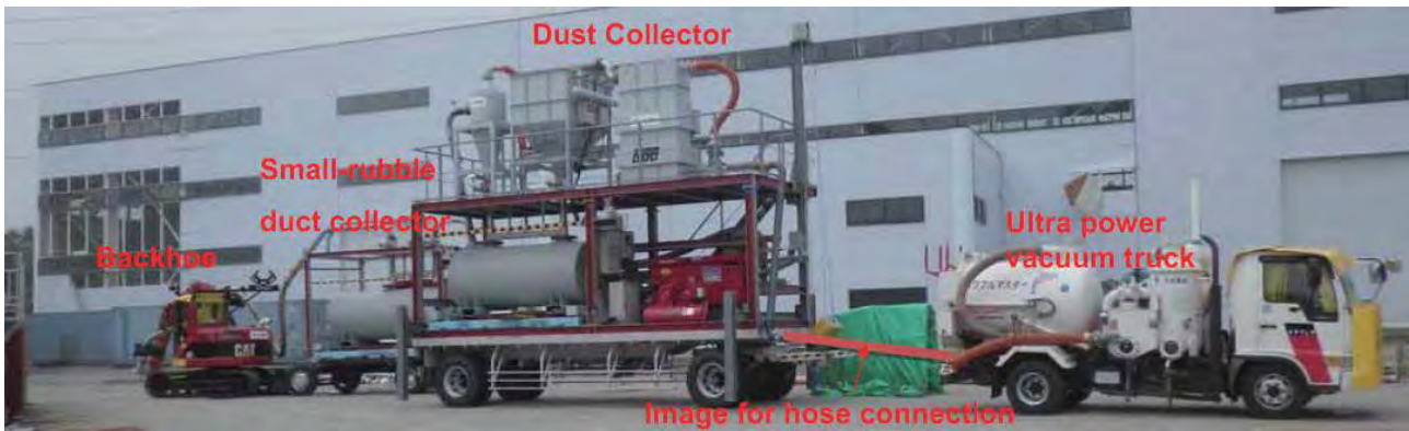
Fig. 1 Sistema di decontaminazione in depressione mobile usato per decontaminare le zone esterne.
