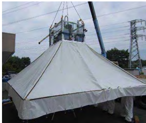
Fig. 2 Sistema usato per campionare posizionato tramite gru
