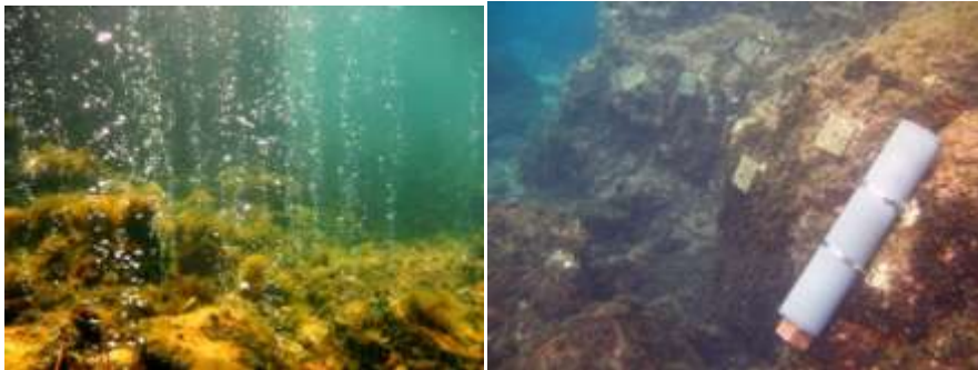
Fig. 1c)- Castello (lato sud) fumarole di CO 2 con dense coperture algali (Foto: Luca Tiberti). Fig. 1d) Castello (lato sud): pH-metro in situ e mattonelle di pietra lavica per esperimenti di colonizzazione e successione ecologica (Foto: Kristy Kroeker).
