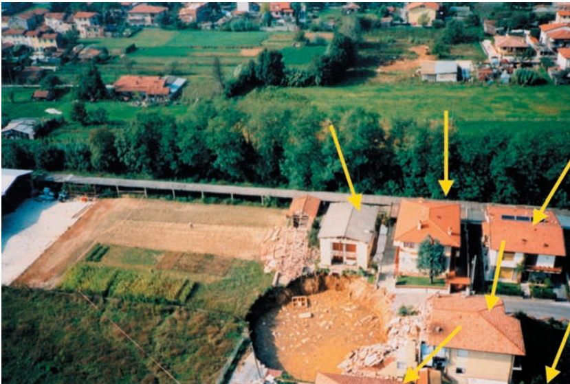
Fig. 1 - Foto dell'area in via F.lli Cervi del Comune di Camaioie interessata il 15 ottobre 1995 dal fenomeno di sinkhole. Un fabbricato quadrifamiliare fu parzialmente inghiottito nella voragine di 30-40 m creatisi in seguito al fenomeno di sprofondamento. Altri cinque fabbricati, indicati in figura con delle frecce, furono gravemente danneggiati.
