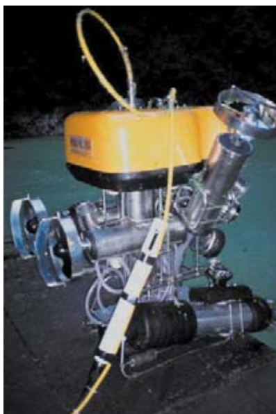
Fig. 27 - ROV Prometeo con la sonda multiparametrica
