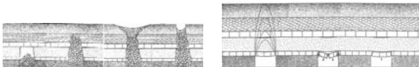
Fig. 7 - Evoluzione del camino di subsidenza e meccanismi di rottura al tetto della cavità (da Karfakis M.G.- 1993)
