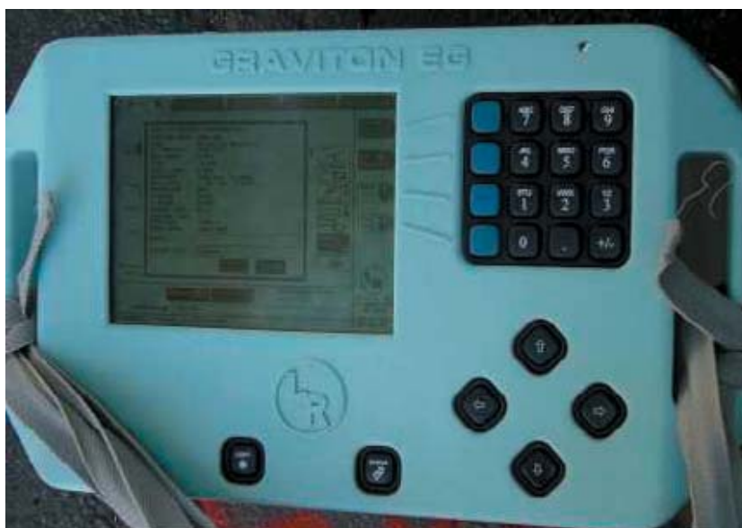
Fig. 1 - il microgravimetro LaCoste & Romberg Graviton EG, utilizzato per la prospezione microgravimetrica.
