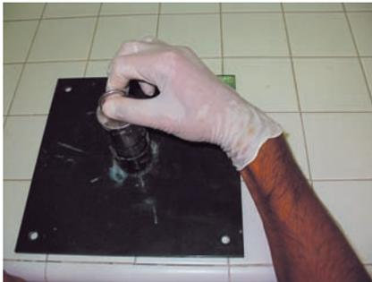
Fig.2- Fase di incollaggio del semibicchiere superiore
