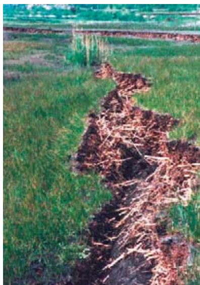
Foto 9: Andamento sinuoso delle linee di frattura, sviluppatasi intorno al Lago Verde, con evidenti piani di rottura ad inclinazione variabile (45-80°).
