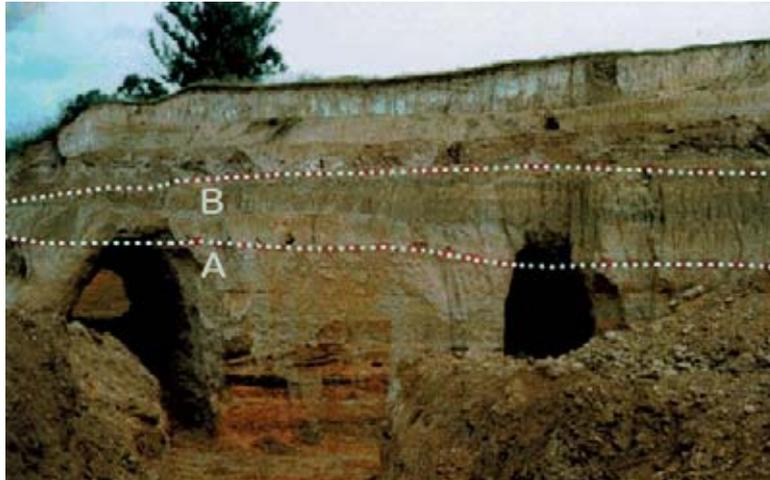
Fig. 8 - Cunicoli di ingresso delle cave di ghiaia rinvenute negli scavi condotti nel marzo del 2002, tra via del Ponte Pisano e via Portuense, alla base del pendio sulla cui sommità è situato l'esteso edificio IACP "Corviale". E' visibile la formazione di Ponte Galeria (PG1) con: A) i sedimenti ghiaiosi oggetto della coltivazione su cui poggiano superiormente B) limi e argille. (foto per gentile concessione del Prof. M. Sciotti).
