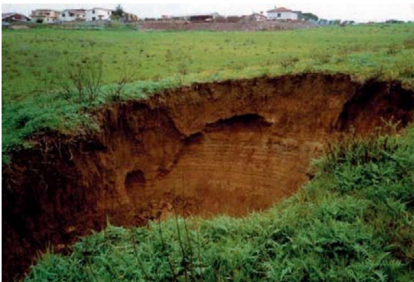
Fig. 10 - Sinkhole originatosi nei primi mesi del 2004 in prossimità di via del fosso della Torretta. Lo sprofondamento presenta una forma subcircolare con una larghezza media di circa 6 metri per una profondità stimata di 4 m. Ricade in un'area territoriale interessata dalla localizzazione, secondo quanto previsto dal Nuovo Piano Regolatore, di un insediamento a carattere prevalentemente residenziale (A.T.O. R 72).
