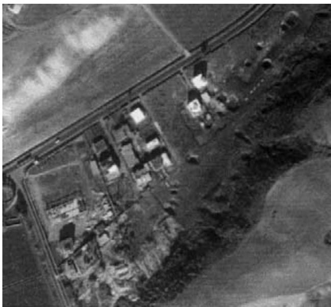
Fig. 7 - Rilevamento di sinkholes di origine antropica situati nel fondovalle posto tra via Portuense e via del Fosso della Magliana originatisi per cedimento delle volte della rete caveale sotterranea. Stralcio di fotografia aerea S.A.R.A. – Nistri, S.r.l., volo anno 1958, fotogramma 3302 – 4476.
