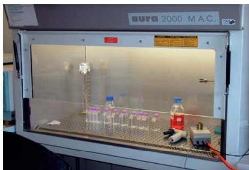
Cappa a flusso laminare verticale di classe II A
