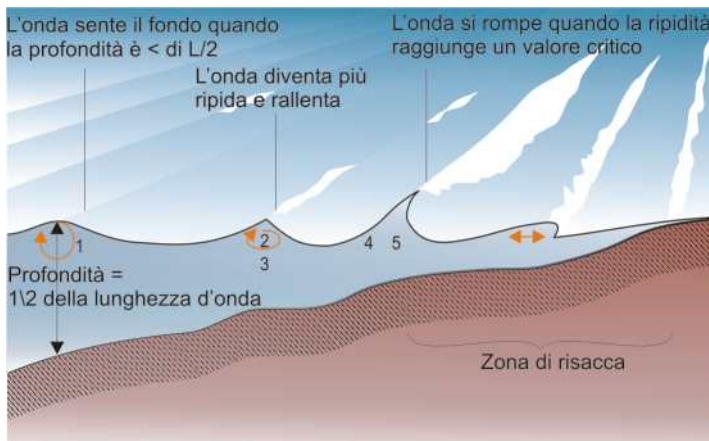
Figura 2.2.8: In prossimità della battigia l'altezza dell'onda aumenta e le creste diventano più ravvicinate.
