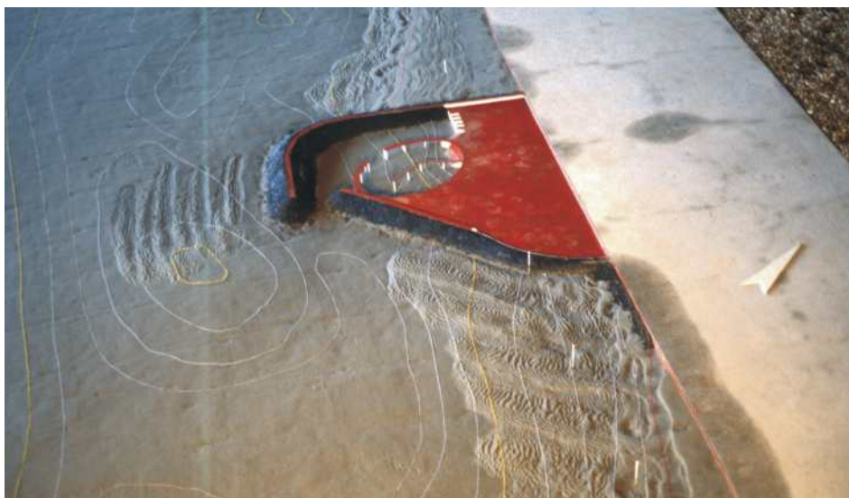
Figura 3.3.6: L'adozione di scale distorte consente, in generale, una buona riproduzione dei fenomeni di rifrazione del moto ondoso, risultando, invece, più carente per riflessione e diffrazione, tuttavia tale limitazione non riveste normalmente importanza determinante ai fini dello studio del movimento del materiale di fondo. (ESTRAMED s.p.a., 1990).
