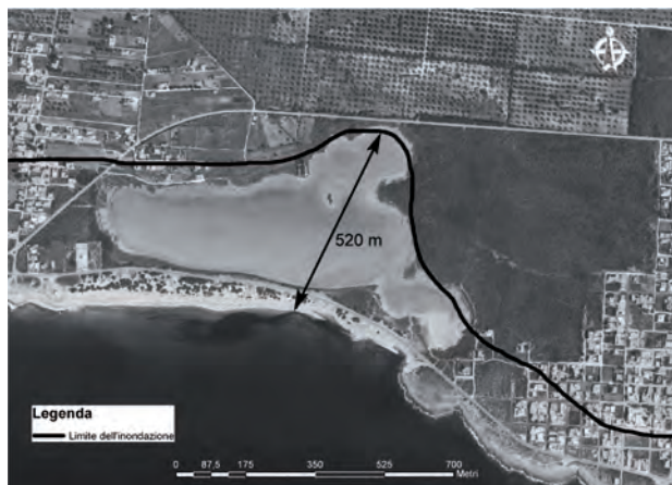
Fig. 12 - Il massimo limite di inondazione in località Vecchia Salina nei pressi di Torre Colimena (Lecce) calcolato considerando, secondo la formula di HILLS & MADER (1997), l'onda estrema di 3,01 m necessaria per spostare il blocco di 80 t rilevato presso Torre Squillace. - Maximum inundation limit estimated at Vecchia Salina locality near Torre Colimena (Lecce). This inundation limit have been obtained using a tsunami wave, 3.01 m high, in the HILLS & MADER (1997) formula.
