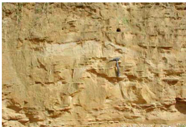
Fig. 9 - Porzione intermedia delle Sabbie gialle con panchina, appena sopra il primo orizzonte di panchina intercettato dalla galleria artificiale intermedia. Sono ben visibili alcuni livelli sabbiosi fortemente cementati, caratteristici di questo membro della formazione di Monte Mario. - Middle portion of the Sabbie gialle con panchina, just above the first panchina horizon tunnelled by the middle artificial gallery. Some cemented sand levels characterize this member of the Monte Mario Fm.
