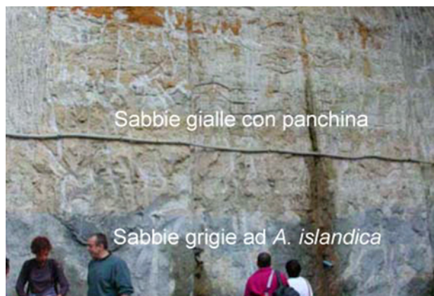
Fig. 8 - Passaggio stratigrafico dalle Sabbie grigie ad A. islandica alle soprastanti Sabbie gialle con panchina (galleria artificiale intermedia). - Stratigraphic boundary between the Sabbie grigie ad A. islandica and the overlying Sabbie gialle con panchina (middle artificial gallery).
