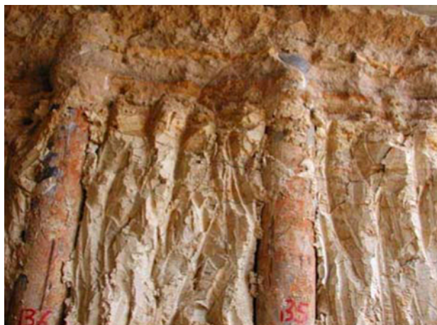
Fig. 12 - Membro delle Argille, sabbie e limi con Cerastoderma , porzione basale. Nella foto sono raffigurate argille e limi, ricche in molluschi marini, che, nella parte alta, passano ad alternanze tra limi e sabbie. Galleria artificiale Via Sappada-Via Trionfale.
