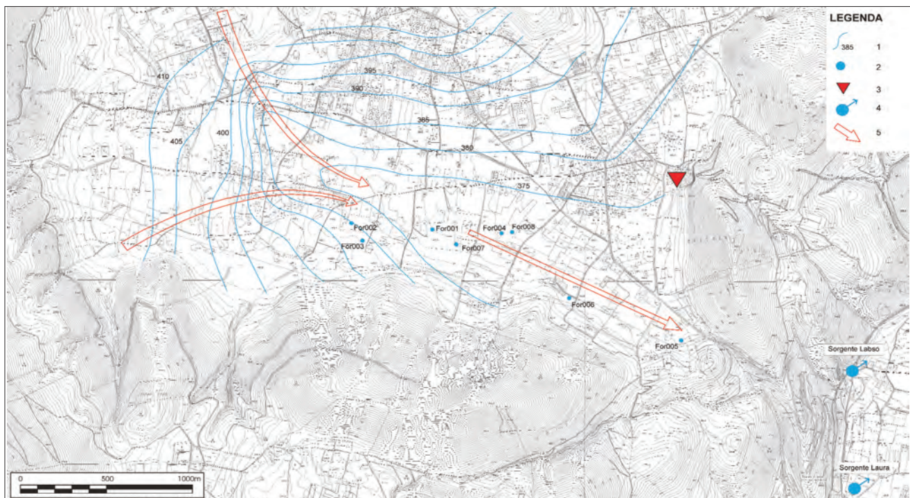
Fig. 70 - Isopiezometriche della falda della piana di Forino (da SANTO et alii, 1998, mod.). Legenda: 1) curva isopiezometrica e relativa quota s.l.m.; 2) sinkhole; 3) inghiottitoio; 4) sorgente; 5) linea di deflusso sotterraneo. - Isopiezometric curve of Forino plain (from SANTO et alii, 1998, mod.). Legend: 1) isopiezometric curve and altitude above sea-level; 2) sinkhole; 3) ponors; 4) spring; 5) underground flow direction.
