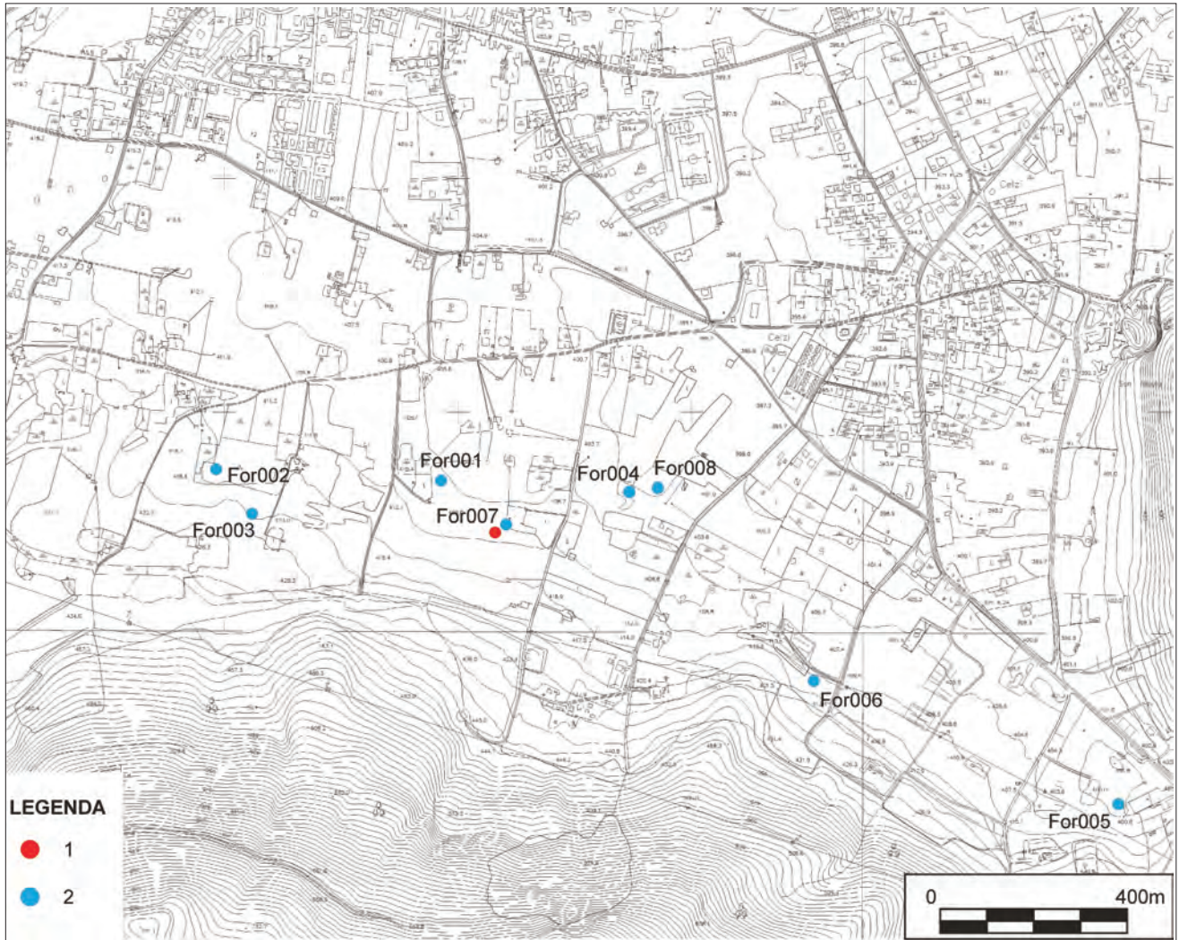
Fig. 71 - Ubicazione dei sinkholes (1) censiti nel settore meridionale della piana di Forino e del sondaggio geognostico (2) effettuato. Il sinkhole riportato con il codice For007 corrisponde a quello generatosi il 12 giugno 2005, mentre quello con il codice For006 a sinkhole del marzo 2005. - Location of southern Forino plain sinkholes (1) and borehole (2). the sinkhole For007 was occurred 2005 June 12; while the sinkhole For006 was occurred in 2005 March.
