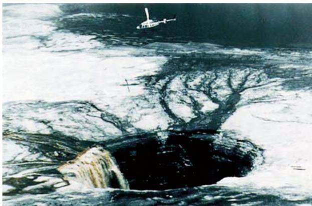
Fig. 3 - Sinkhole profondo 140 metri, apertosi in un deposito di gesso il 15 Giugno 1994 nella Florida centrale. La voragine così prodotta ha scaricato più di 100.000 m<sup>3</sup> di gesso e acque tossiche e radioattive all'interno dell'acquifero della Florida, che fornisce il 90% dell'acqua potabile dello stato. Si noti l'elicottero nella foto, per scala (foto da: US News & World Report, 12 Giugno 1995).
