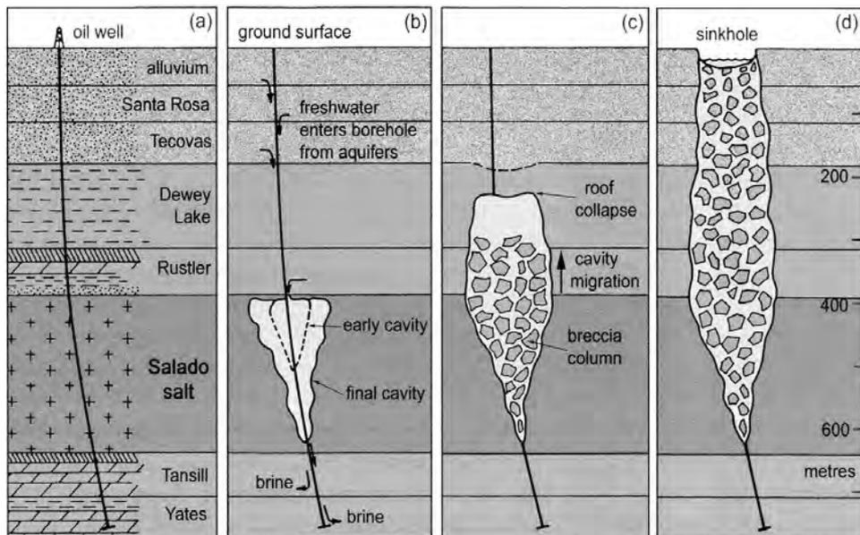
Fig. 7 - Sezioni schematiche illustrative della formazione del *sinkhole* Wink Sink # 1 (da JOHNSON, 2005a): a) pozzo di estrazione petrolifera realizzato nel 1928; b) sviluppo ed ampliamento della cavità da dissoluzione nel sale, durante e dopo l'estrazione del petrolio; c) migrazione verso l'alto della cavità attraverso i sovrastanti depositi; d) collasso in superficie con formazione del *sinkhole* nel 1980.
