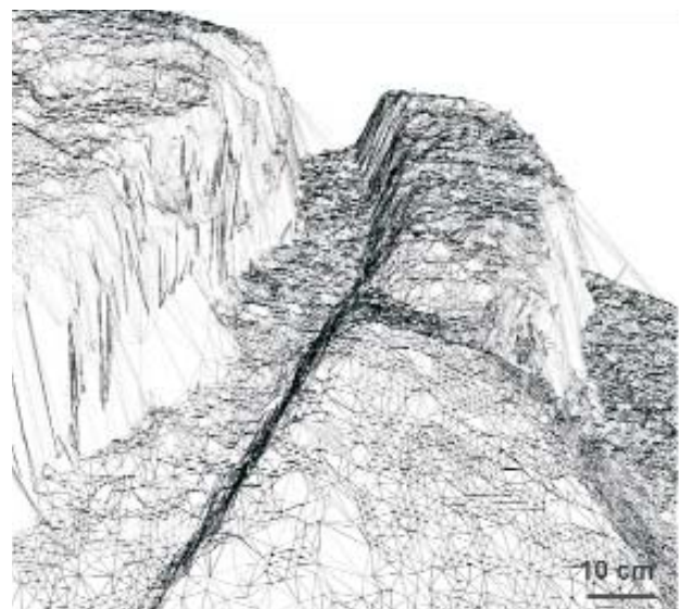
Fig. 12 – 3-D modelling of a water-channel. – Modellizzazione 3D di un canale.
