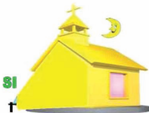
Fig. 14 – L'illuminazione dal basso, va riservata ai soli edifici di grande importanza storica. Il fascio di luce deve però rimanere interamente contenuto entro la sagoma dell'edificio. (Fonte: www.cielobuio.org )
