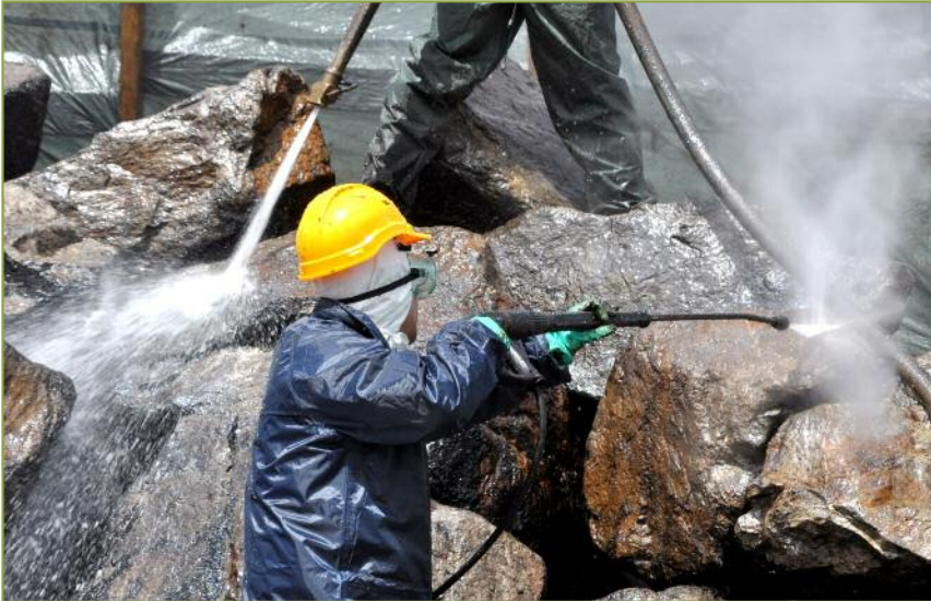
Figura 26: Usualmente la bonifica delle coste rocciose viene eseguita con l'impiego di idropulitrici (fonte CEDRE)
