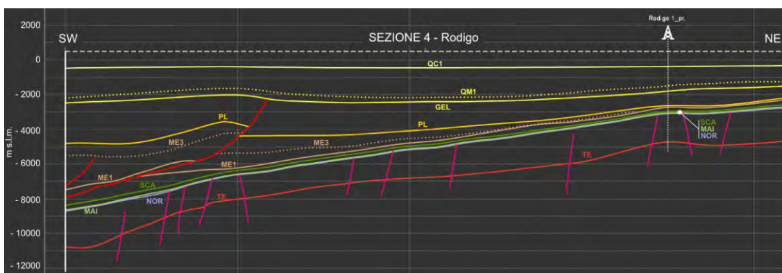
Figura 7.19 - Sezione geologica estratta dal modello 3D.
