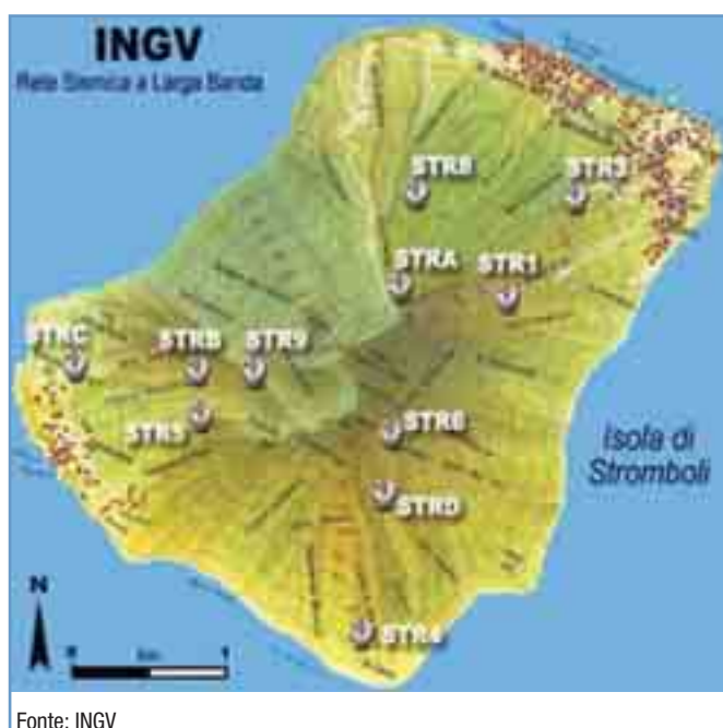
Figura 18.11: Distribuzione delle stazioni della rete sismica a larga banda sull'isola di Stromboli (2003)
