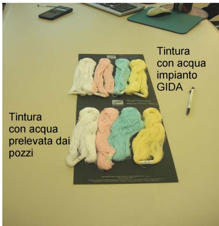
Figura 11: risultati delle prove di tintura effettuate sui filati
