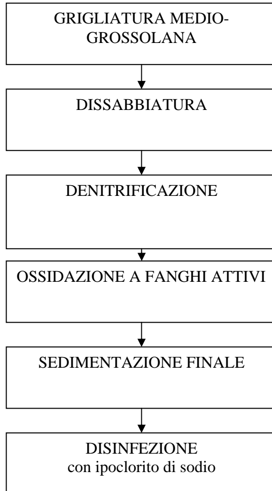
Figura 27: schema a blocchi dell'impianto di Montenero di Bisaccia
