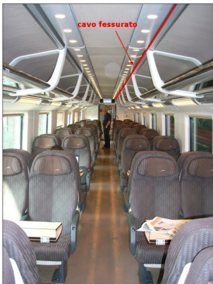
Figura 1: Disposizione del cavo fessurato nella carrozza (ESAV 9699 e ESAV 9526) 18
