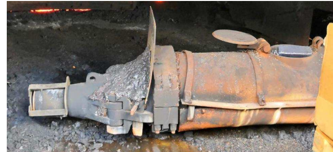
cannone per chiusura foro di colata appena caricato con le masse a tappare
