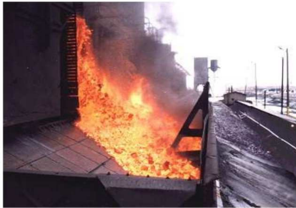
Operazione di sfornamento del coke
