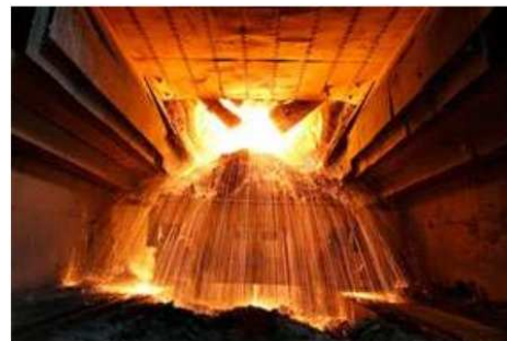
Fase di soffiaggio dell'ossigeno
