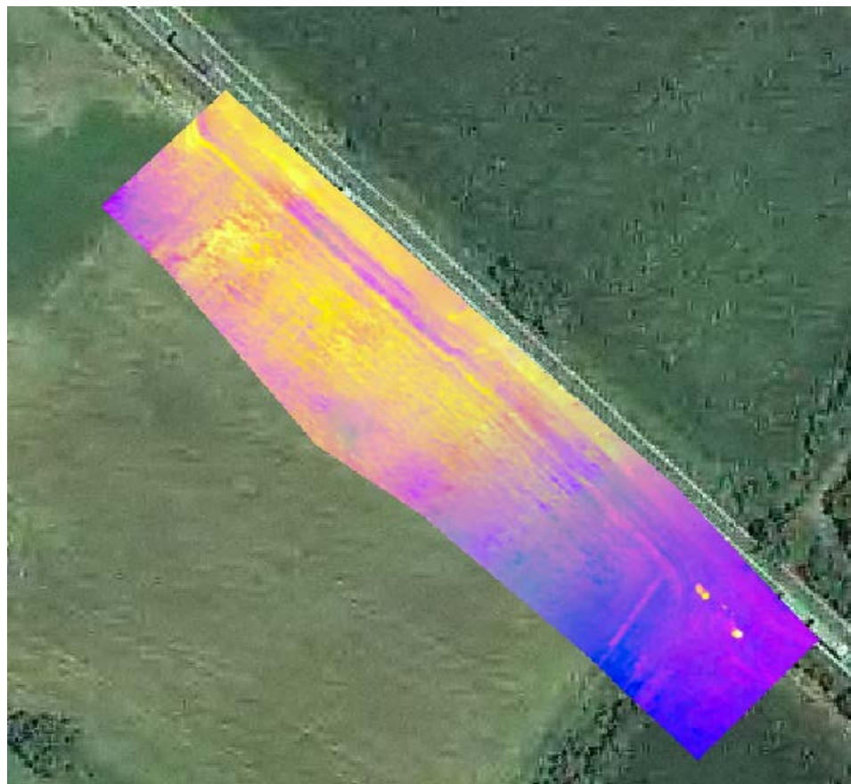
Mappa della temperatura radiante del suolo acquisita da termocamera, risoluzione 6 cm.
