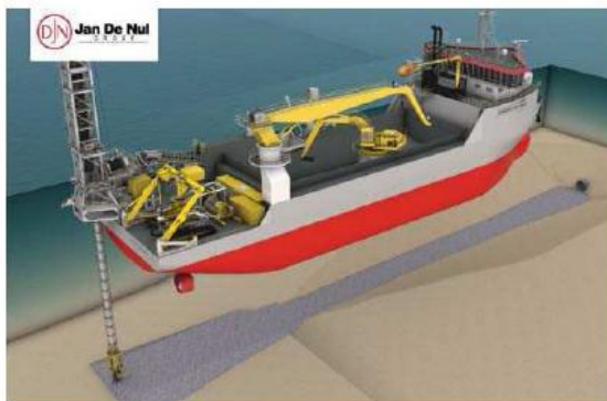
Figura 3-30: Riempimento del terrapieno da parte della nave
