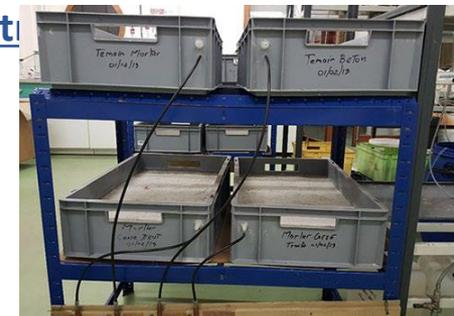
**Allestimento di lisimetri**, in cui sono state simulate e controllate specifiche condizioni ambientali e meteorologiche, al fine di valutare una **bioremediation naturale** dei sedimenti contaminati ed il trasferimento dei contaminanti nelle matrici acquose.
