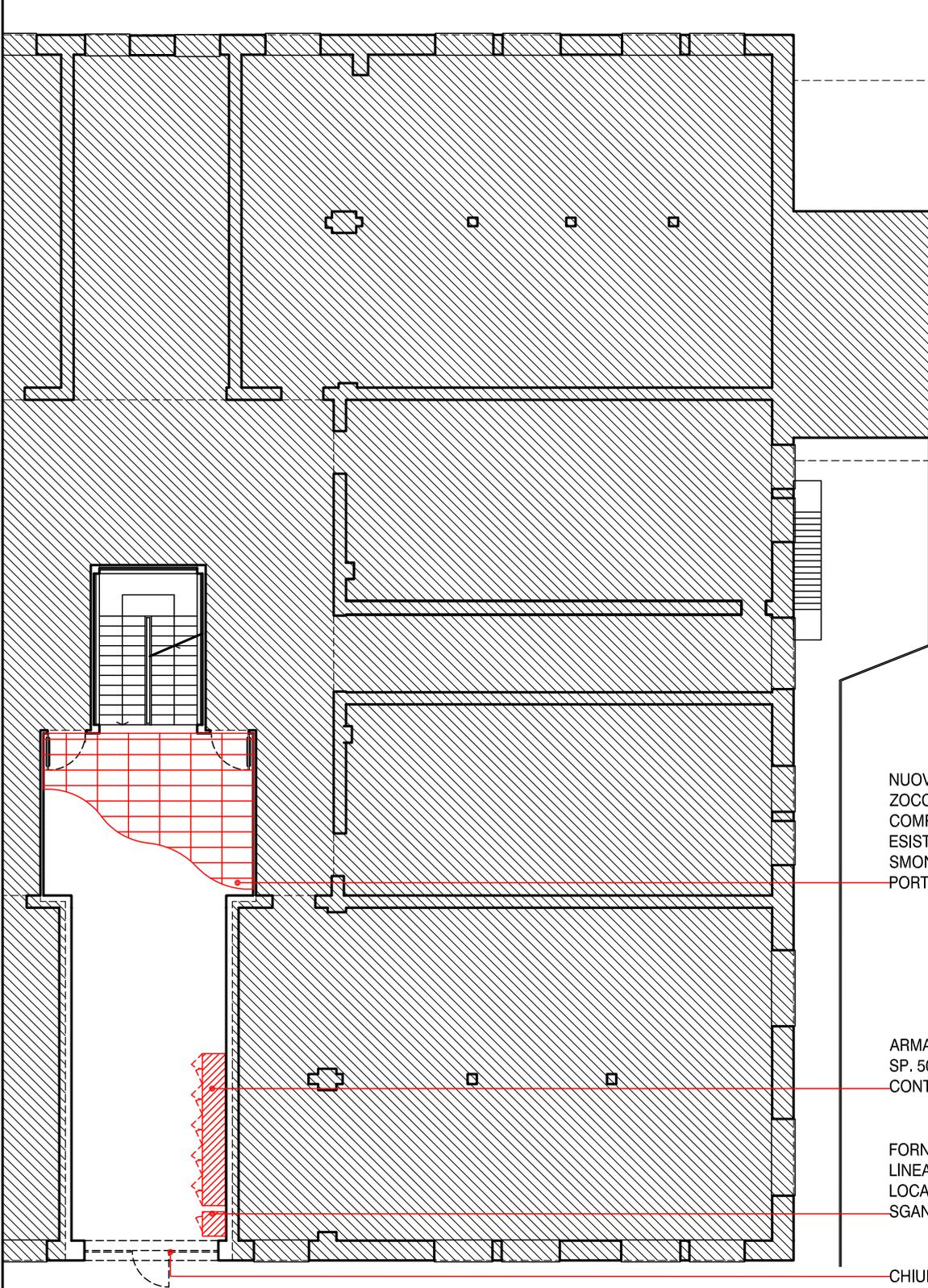
NUOVA PAVIMENTAZIONE IN GRES, ZOCOLINO, SOGLIE, STUCCATURE, COMPRESO RIMOZIONE PAVIMENTAZIONE ESISTENTE, OVVERO SOVRAPPONESTA CON SMONTAGGIO E RIMONTAGGIO PORTE E RIPRISTINO.
