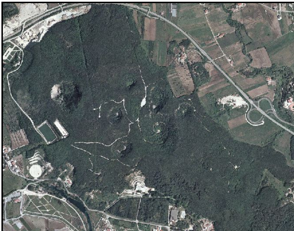
Fig. 12 – Panoramica da foto aerea dei fenomeni di sprofondamento presenti sul rilievo di Montepugliano.
