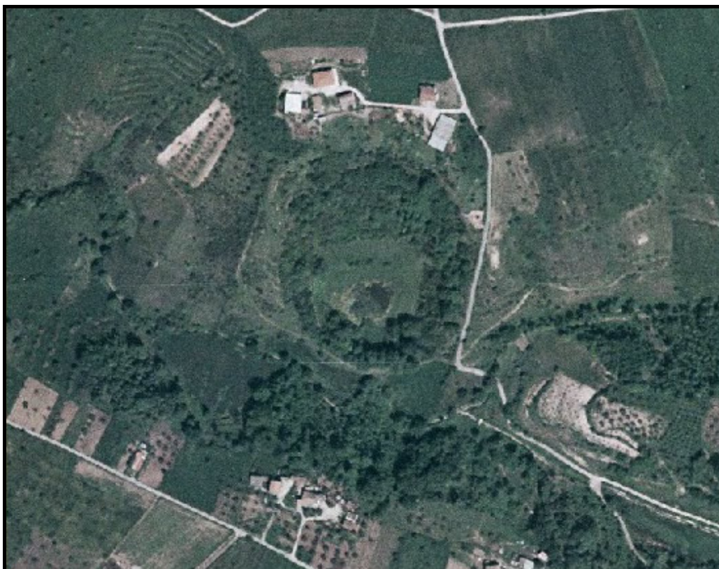
Fig. 34 – Ortofoto a colori che mostra lo sprofondamento di Fossa dei Bagni ed il lago formatosi al suo interno.
