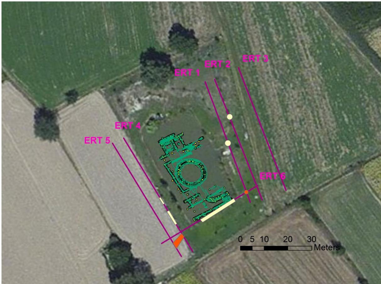
Fig. 3: principali anomalie individuate nel sottosuolo (colore rosso) e anomalie minori (colore giallo).
