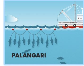
Il palangaro o palamito è un attrezzo da pesca che impiega simultaneamente più ami con le esche, apposti su fili di nylon in una trave (cavo principale) lunga anche diverse centinaia di metri.
