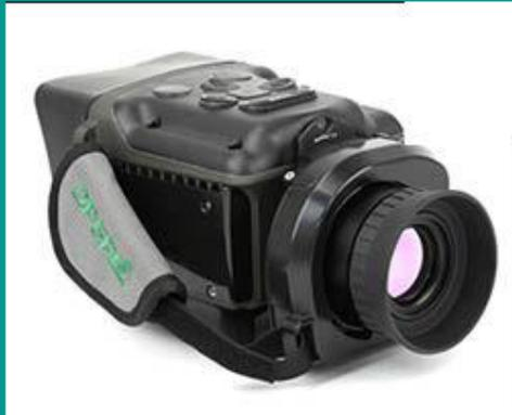
Esempio di optical gas imaging camera
