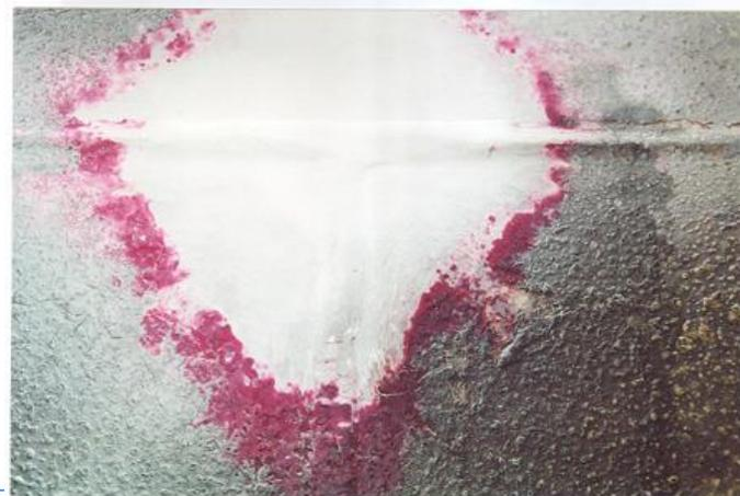
MANTELLO: RIPRISTINO DELLA SALDATURA DIFETTOSA E CONTROLLO P.T. FINALE, CON RISULTATO FAVOREVOLE.
