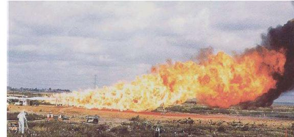
La LG evidenzia che, a parità di evento incidentale, **le aree di danno** individuate per gli scenari di **Jet-fire** sono in ogni caso **ricomprese all'interno delle aree di danno** individuate per i scenari di **Flash fire**
