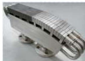
Prototipo a media scala del pannello verticale del direttore di ITER, realizzato con leghe in tungsteno (parte piano) e composito in fibre di carbonio (parte curva) realizzato nell'ambito di una collaborazione tra ENEA e Ansaldo Ricerca
